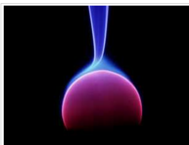
Centrální elektroda lampy plazmy, představení vřelé modré plazmové dělení nahoru. Barvy jsou výsledkem radiative rekombinace elektronů a iontů a uvolnění elektronů v vybuzených stavech zpátky do nižších energetických stavů. Tyto procesy vyzařují světlo ve spektru charakteristickém pro plyn být vzrušený.
